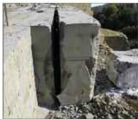
Fasi di distacco di un blocco di arenaria nella cava Bresciani a Gandosso
