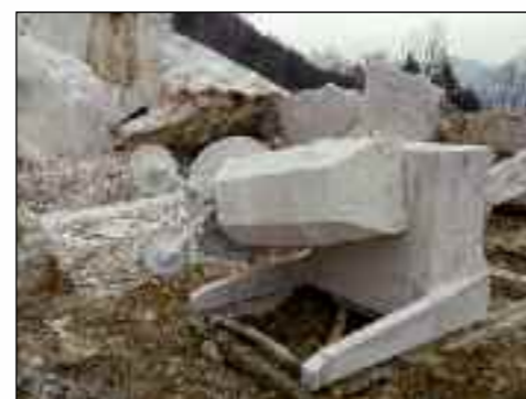
Taglio a filo diamantato di un blocco informe
