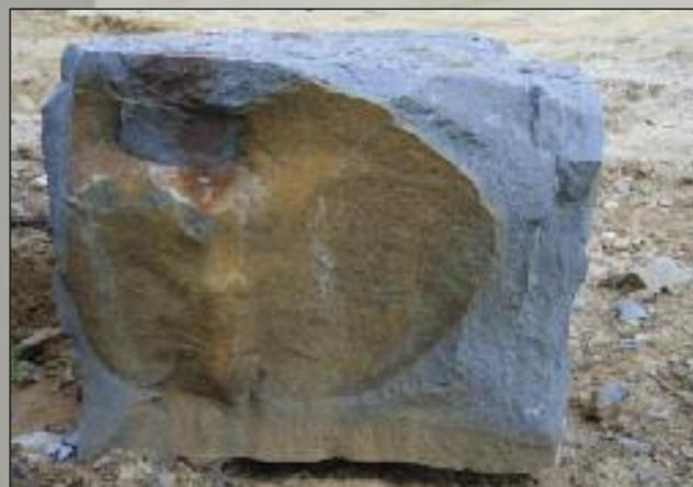
Alterazione in ossidi di ferro in un blocco di arenaria
