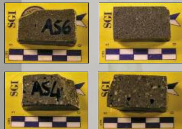
Provini prismatici di arenarie a diversa granulometria predisposti per le prove di laboratorio
