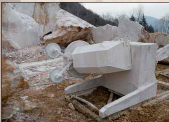
Taglio a filo diamantato di un blocco informe
